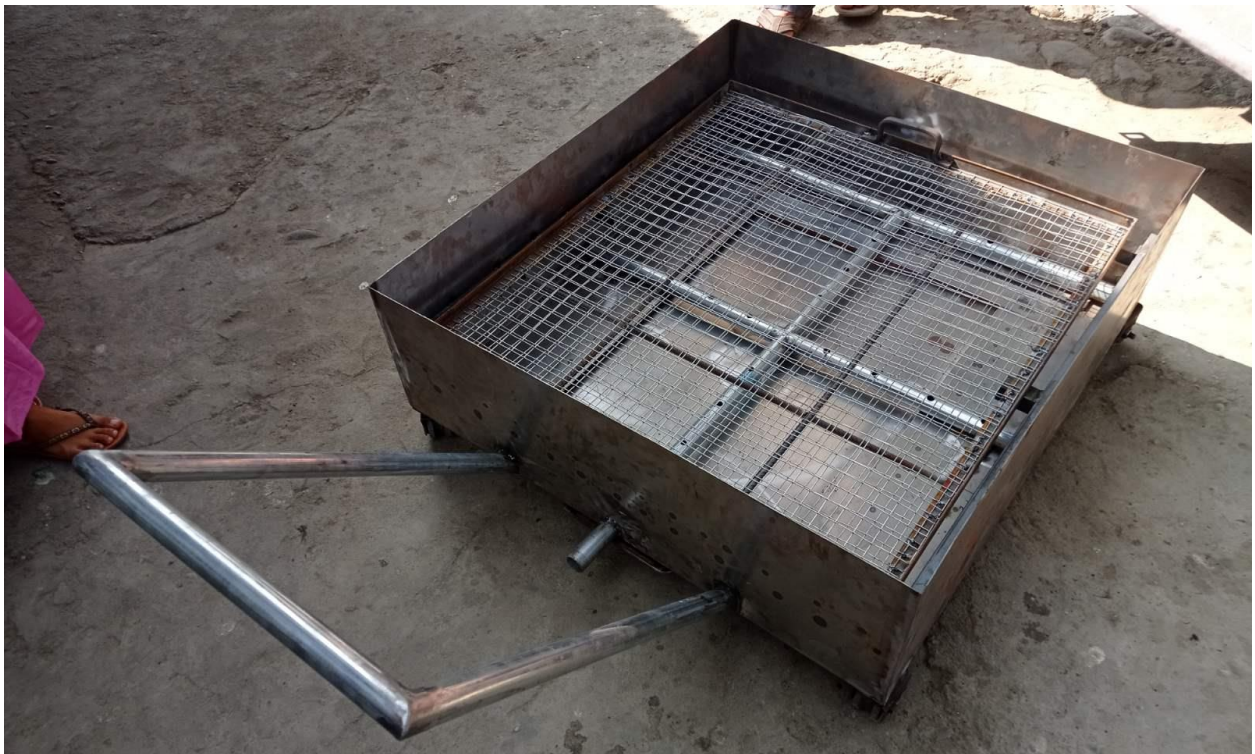
ပုံ (၄၈) - ထင်းများအတွက် နေရာလုံလောက်မှု ရှိစေရန် မီးကျိုးခဲ/မီးသွေးတင်ကောအား လေပြန်များ၏ အပေါ်နားတွင်ကပ်၍ တပ်ဆင်ခြင်း
