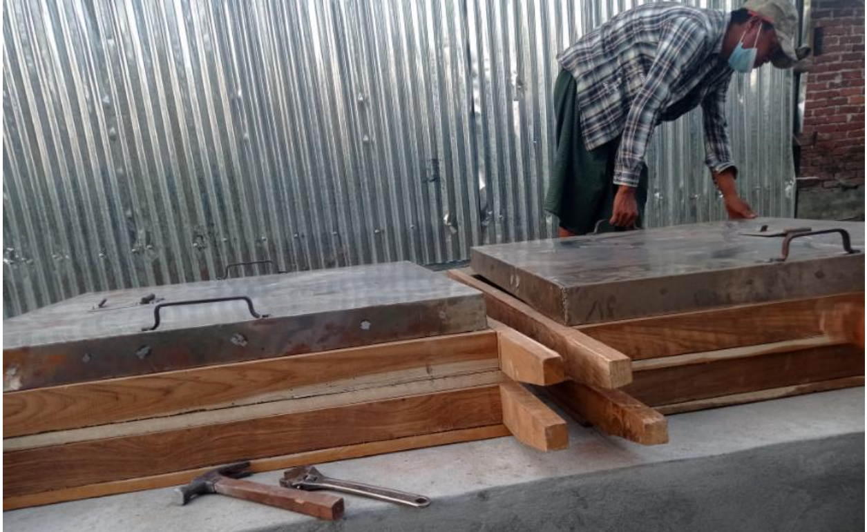
ပုံ (၂၉) - မီးခိုးကျပ်တိုက်နိုင်သည့်ပမာဏ မြင့်မားလာစေရန် အပိုထပ်ဆောင်းထည့်သွင်းသော သစ်သားဗန်းများ
