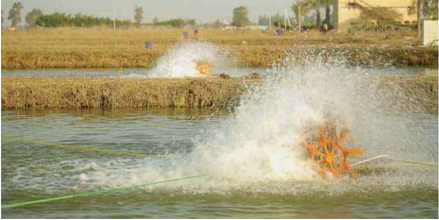
شكل ١٢: تستخدم البدلات الكهربائية لتهوية الأحواض ورفع مستوى الأكسجين الذائب في الماء
